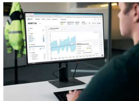
Zauberkasten: Der Konux-Sensor im Einsatz (l.). Die Analyse der gesendeten Daten (o.) ergibt ein genaues Bild der Zustände am Gleis.
